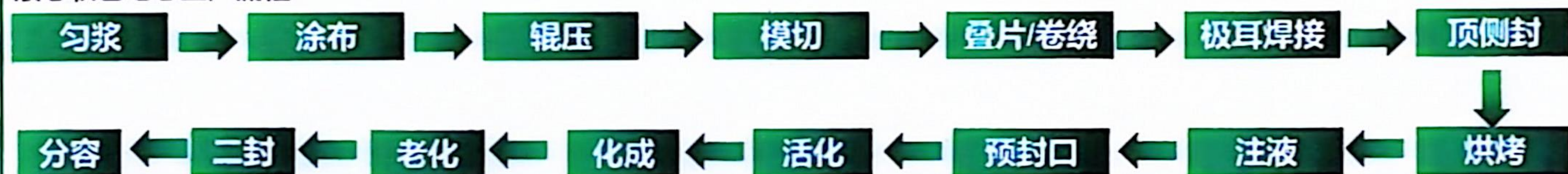
液态软包电芯生产流程
