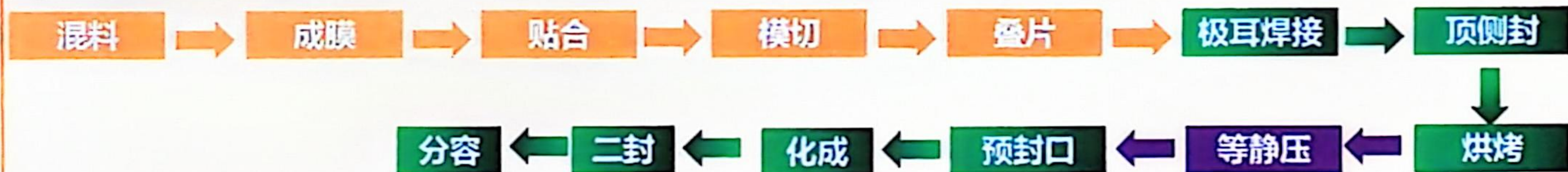
全固态软包电芯生产流程（干法路线）液态设备利用率约为26%，标■为需要匹配固态重新设计的设备，标■为新增设备
