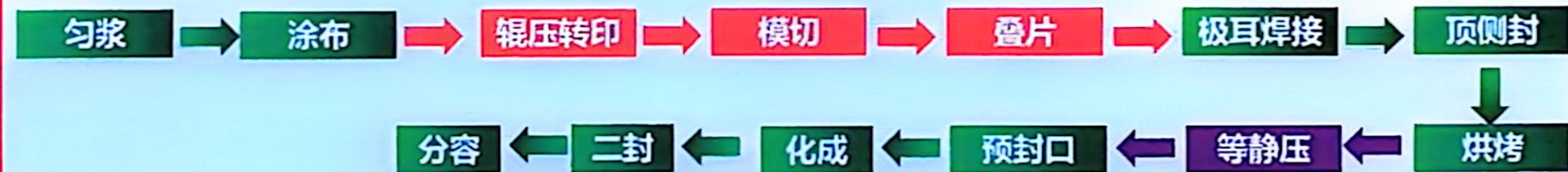
全固态软包电芯生产流程（干法路线）液态设备利用率约为26%，标■为需要匹配固态重新设计的设备，标■为新增设备
